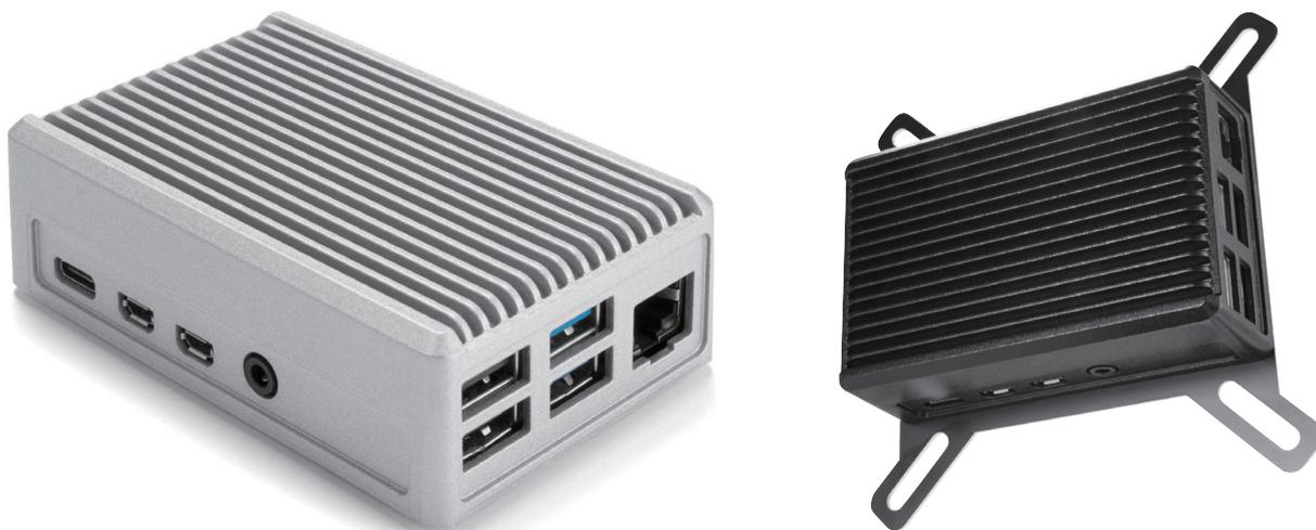
Raspberry Pi 4B専用の放熱型ヒートシンクケースです。カバーはアルミダイキャスト製で強度にも優れています。発熱量の多いCPU、RAMに接触する熱伝導突起付・熱伝導シート付タイプと、低価格の突起無しタイプが選択可能です。価格は、突起無しタイプが¥1,780、熱伝導突起付タイプが¥1,960と高機能でコストパフォーマンスが高い製品です。標準のデスクトップタイプ、壁付フランジタイプ、DINレール取付タイプの3タイプを用意しております。
