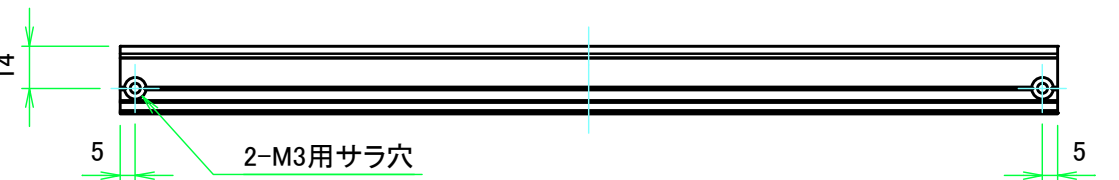
2-M3用サラ穴 2-M3 Countersunk ※ 反対面も同様 / Same on the other side.
