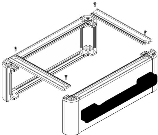
D 製品を裏返し、④パネルを③フレームの溝にはめ込む。
