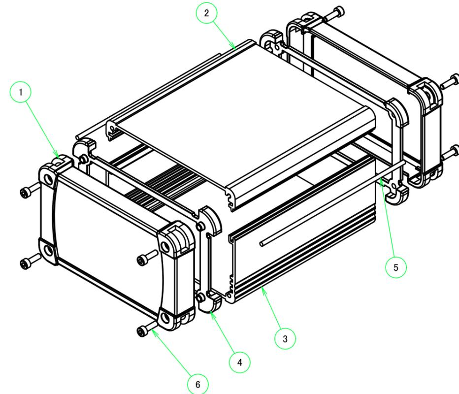
※取付ビスの締付けの強弱によりガスケットが伸縮するためD寸法(全長)は多少変化します。
