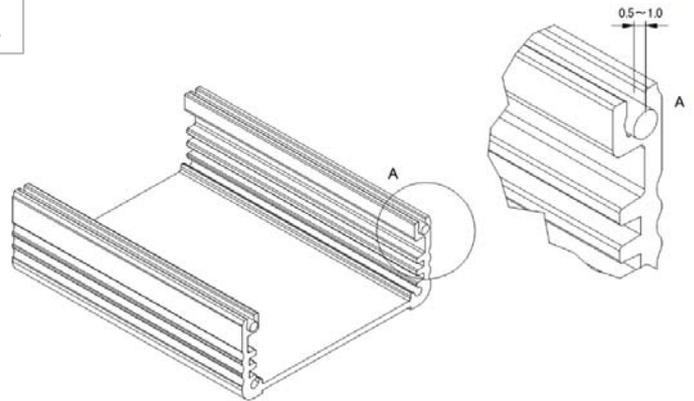
カバー用ガスケットを取り付ける。ガスケットは、下カバーより少し長くなっています。
