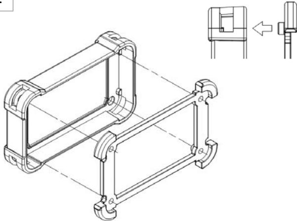
パネルにコーナーガード付ガスケットを取り付ける。
