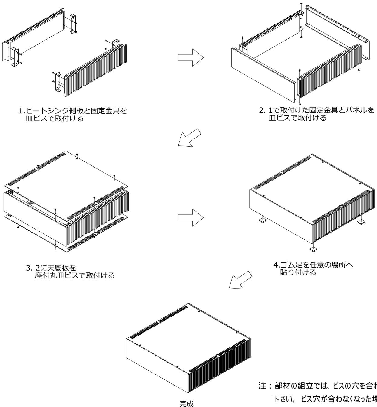
注：部材の組立では、ビスの穴を合わせて組立て下さい。ビス穴が合わなくなった場合は、ビスをゆるめ、ビスの穴位置をあわせて下さい。
