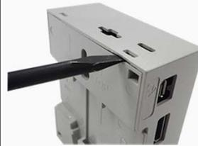
2 ②ベース裏面よりベース爪部の固定部にマイナスドライバーを差し込み、取り外す。
