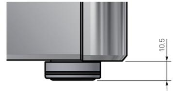
■ シールドガasketは、側板の溝・コーナーブロックの溝に貼り付けて取付けて下さい。
