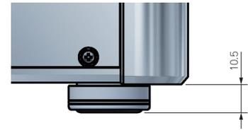
■ アルミダイキャスト製のコーナーブロックの内側にタップ穴 (ねじ切り穴) が付いていますので、基板やオプションのシャーシが取付し易くなっています。シャーシの取付方法は、P6-32をご参照下さい。
