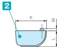
■ EX□シリーズの下カバーの幅が185mm以上にあります。ナットスライド用溝を利用して取り付けることができます。(TLW-70E□のみ)
