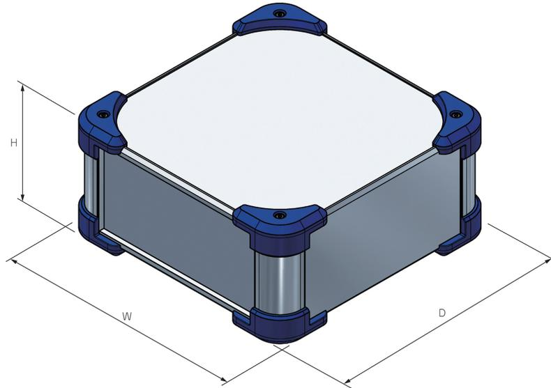
■ アルミダイキャスト製のコーナーブロックの内側に貫通穴が付いていますので、基板やオプションのシャーシが取付し易くなっています。
