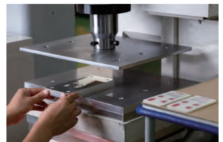
⑥プレスでエンボススイッチ(突起形状)作成
