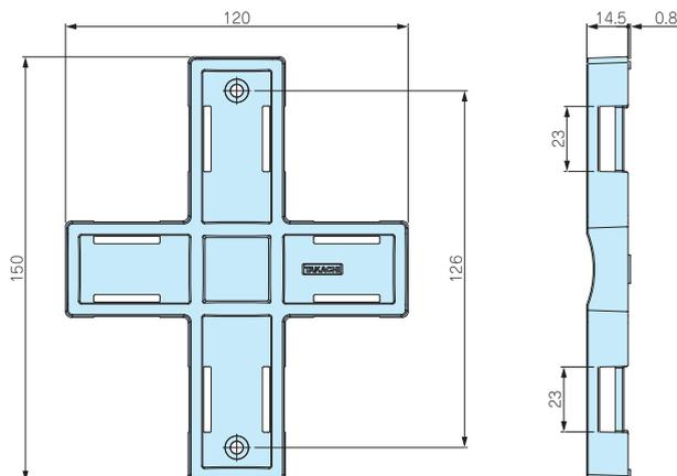
■材質 / 表面処理 : アルミダイキャスト ADC12 / ショットプラスト
