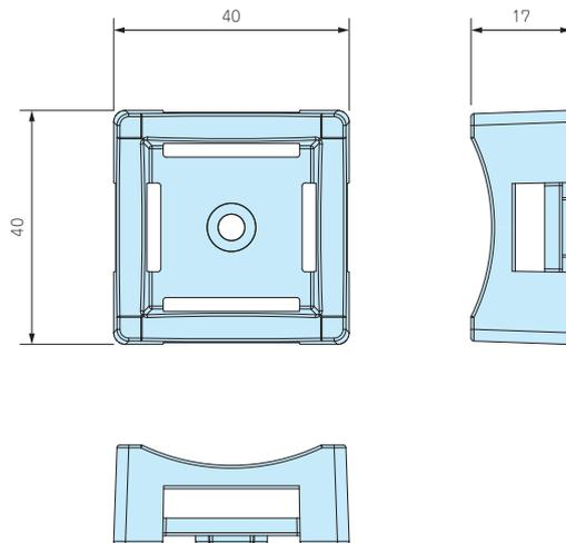
■材質 / 表面処理 : アルミダイキャスト ADC12 / ショットプラスト
