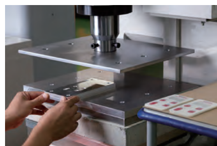
⑥プレスでエンボススイッチ(突起形状)作成
