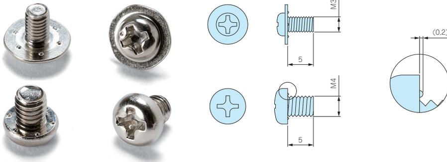
■ビスの裏側に突起が出ておりますので当社製品のアルマイト処理やアルミ塗装材の表面のアルマイト層や塗膜層を削り、材料の素地と接触させます。各種様々な製品にご利用いただけます。
