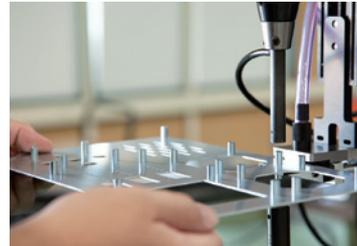
タカチでは専用のプレス機で加工をしますので、安定した強度でスペーサーの取付が可能です。
