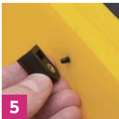
入れ込んだビスにパネルマウントパーツを合わせる。 (インサートナットを上面にする。)
