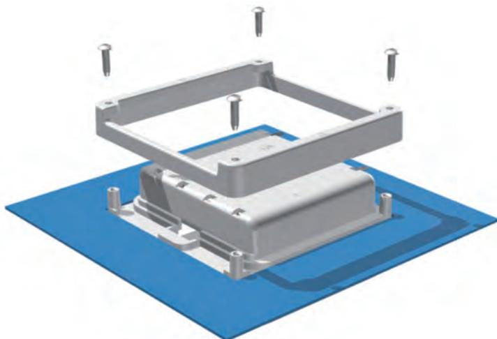
■ BC3-4□のフレームは正方形に近い形状のため下記のように△マークを合わせるように取付けて下さい。
