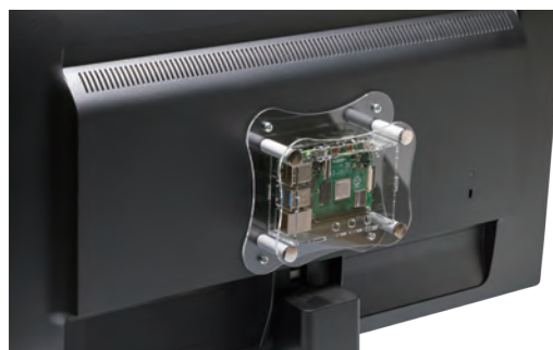
RPA-4B・5-1FはVESA規格の取付ピッチ (100×100mm) に対応しており、PCディスプレイの裏側などに取付が可能です。
