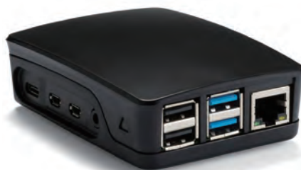
市販プラスチック製ケース 試験結果 CPU温度 58.4°C
