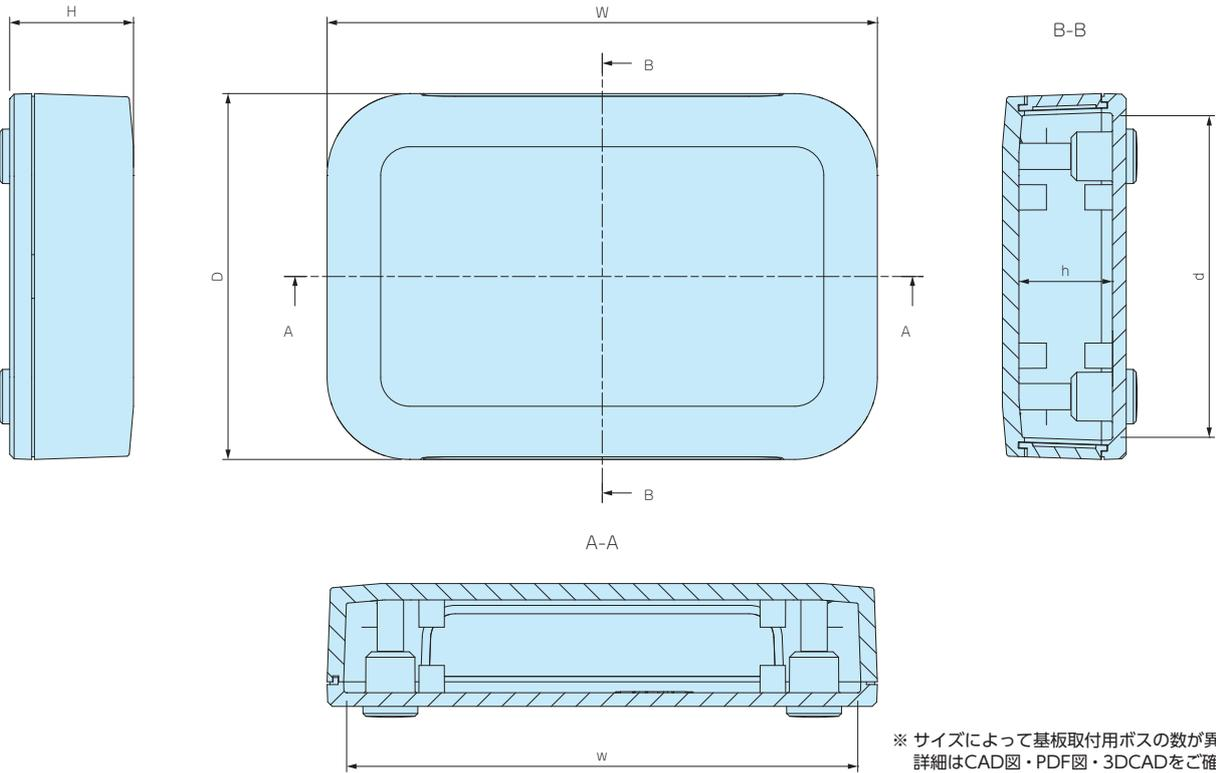
※ サイズによって基板取付用ボスの数が異なります。詳細はCAD図・PDF図・3DCADをご確認ください。
