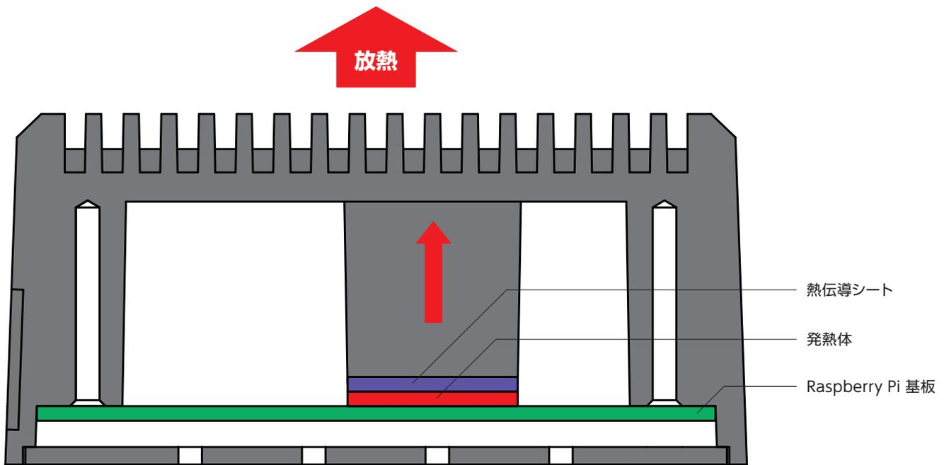
■ 発熱量の多いCPU、RAMに熱伝導シートを貼り付け、ケース内部の突起に接触させる事で熱を上面のヒートシンク部に伝えます。
