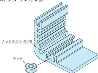
■ フランジブラケットは下記図のようにスライド溝にナットを入れて取付けて下さい。
