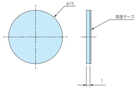
■ AUH開閉カバーを閉じたときの衝撃吸収が出来る緩衝パッドです。開閉カバーと本体の接触面に貼り付けてご利用いただけます。
