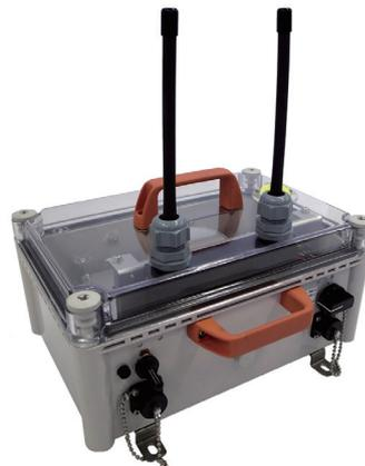
橋梁工事中用傾斜計
