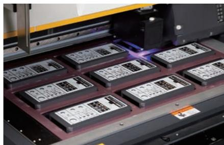
表面シート製作・インクジェット印刷
