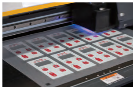
①シートにインクジェット印刷
