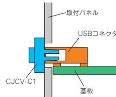
■ タイプC用USBコネクタ内部にCJCVカバーを差し込みます。
