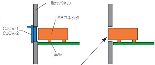
■ タイプA用USBコネクタを取付パネル内壁より前に出すと、USBコネクタとCJCVカバーが干渉してしまいますのでご注意ください。
