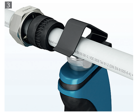
3 シールドケーブルの被覆を剥く。
