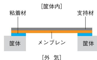
粘着材タイプは、平面さえあれば場所を選ばず使用可能です。携帯機器の防水としても広く使用されています。
