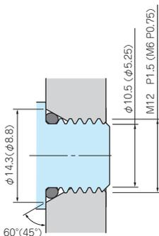
■ 締付け時 Oリングの変形を防ぐため
