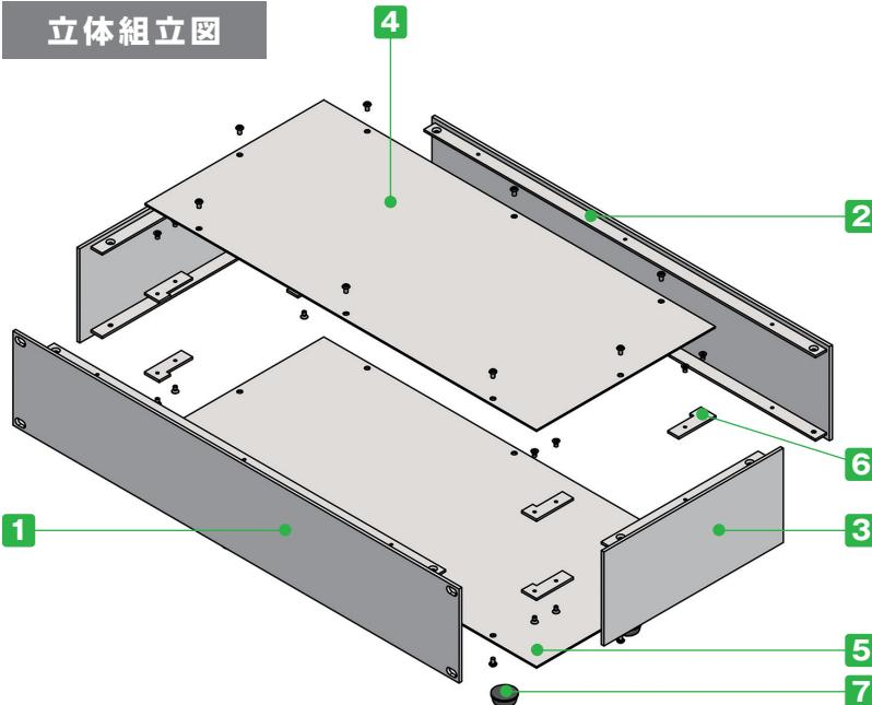
■ 外枠4面がアルミ押出材で構成され、有効幅が424mmと内部有効面積が広い19インチラックケースです。
