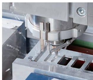
3 CAD/CAM対応工作機械にて加工
