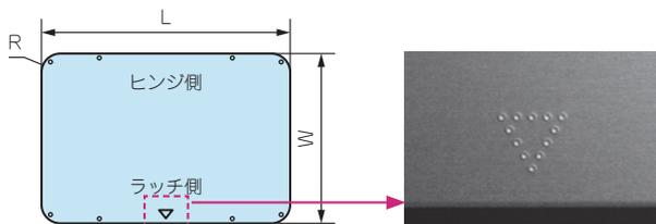
※▽印のあるパネルは、▽印をラッチ側にして取付けて下さい。
