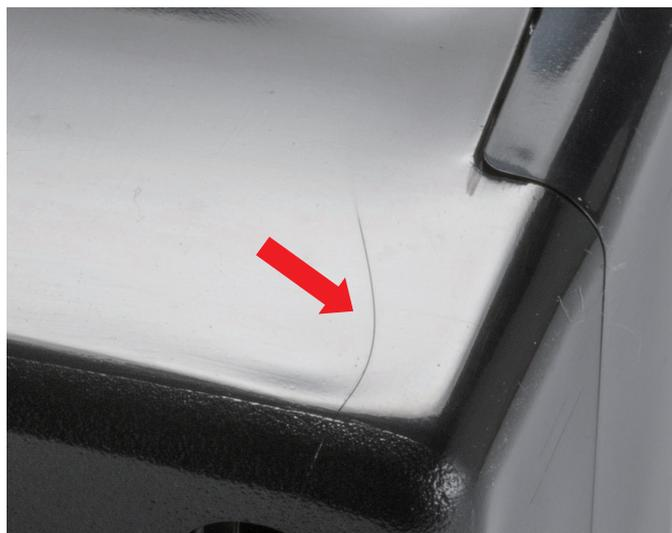
フローマーク：熔融材料の流れの経路が成形品の表面に残る現象
